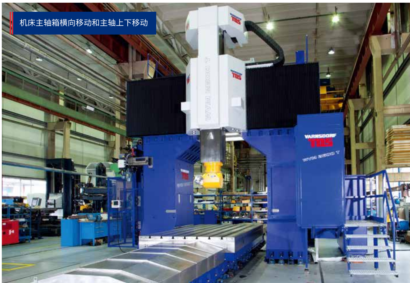
正交式两轴自动分度万能铣头
